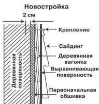
Установка сайдинга поверх существующей обшивки
